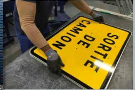
Sur le site principal de Cholet, siège de la société, est fabriqué l'essentiel des panneaux de signalisation ainsi que les séparateurs de voies et autres balises plastiques.
